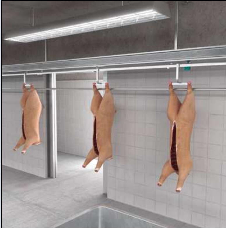
Transport von Schweinehälften über eine EHB
